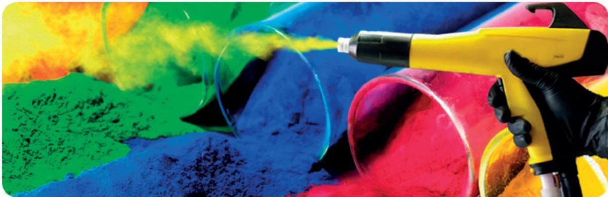
A **pintura eletrostática a pó** é uma das melhores técnicas de revestimento que usa tinta sem solvente. Ela oferece muitas vantagens, por exemplo:
