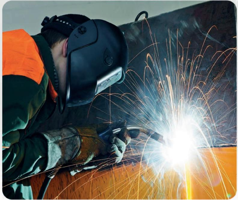
A solda MIG/MAG TIG é um processo de soldagem por arco elétrico entre um metal de base e um consumível em forma de arame, denominado eletrodo não revestido, fornecido por uma alimentação contínua, realizando uma união de materiais metálicos pelo aquecimento e fusão, sob uma atmosfera de proteção gasosa.
