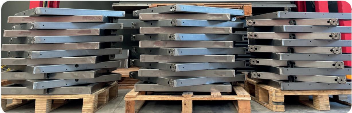
Revestimento do aço com zinco por meio de eletrodeposição. O principal objetivo é impedir o contato do material-base com o meio corrosivo.
