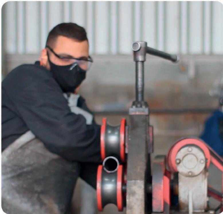
O funcionamento da **Calandra** é relativamente simples. Ela possui rolos em seu interior que modelam a chapa conforme a necessidade. Geralmente são 3 rolos em forma de pirâmide ou 4 rolos que facilitam o processo de pré-curvamento. O material é passado por entre esses rolos que exercem pressão o suficiente para achatá-lo.
